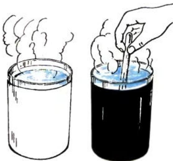
Стаканы, наполненные горячей водой, находятся в одинаковых условиях, разница между ними только в цвете оберток. Если вы сразу, как только заполнили стаканы водой и поставили их на стол, измерите температуру воды в них, то убедитесь, что она одинаковая.
